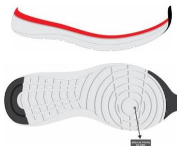
1. **ENTRESSOLA** – peça macia para amortecimento de impactos, constituída composto de resinas base Poliéster na cor branca, localizada na parte intermediária frontal com parte central em contato com o solo, e ponto de giro na parte do 1º metatarso, com acabamento via pintura na cor (conforme imagem). Unida à soleta e ao salto pelo processo denominado colado com aplicação de adesivos a base de água.
